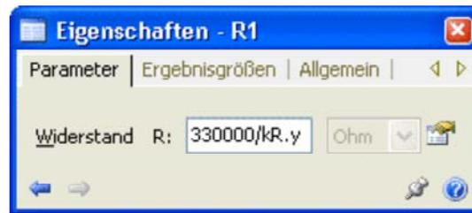
Während der Simulation werden die Widerstandswerte kontinuierlich verringert und damit erhöht sich stetig die Amplitude der Signalspannung bis zu ihrem Maximalwert.
