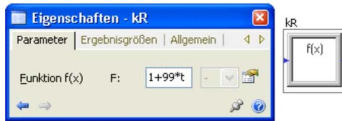
Die Funktion **F** wurde so gewählt, dass im Zeitbereich bis **tStop=1 s** sich der Reduktionsfaktor von 1 auf 100 erhöht.
